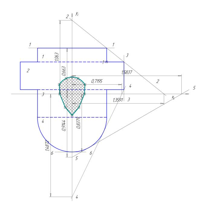
Задача №2 РАСЧЁТ ЦЕНТРАЛЬНО СЖАТОГО СТАЛЬНОГО СТЕРЖНЯ НА УСТОЙЧИВОСТЬ
